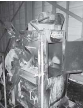
火災で損傷した不燃ごみの 破碎・分別処理器
